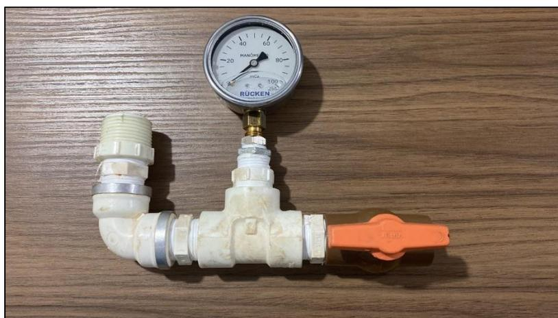
**Imagem 01** – Foto do equipamento utilizado para aferição de pressão.
