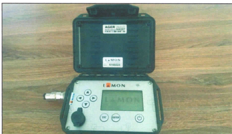
Imagem 01 – Foto do equipamento Datalogger LAMON DP 5100223. Fonte: AGER BARRA.
