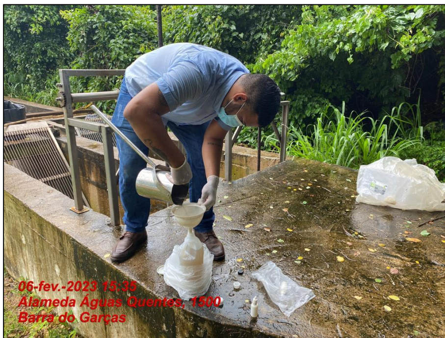
Imagem 01: Detalhe da coleta de esgoto bruto na ETE Anchieta.
