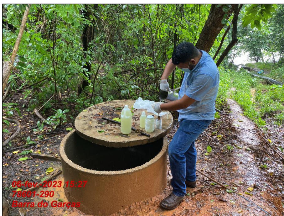
Imagem 02: Detalhe da coleta do esgoto tratado na ETE Anchieta.
