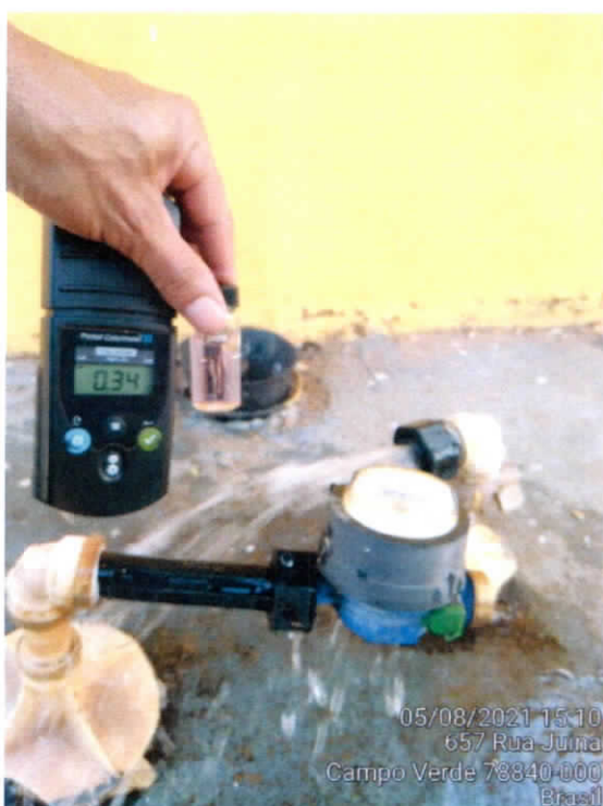
Figura 3. Rua Juina, 657, Vale do Sol - HD Y15S398719 - Cloro Residual Livre igual a 0,34 mg/L
